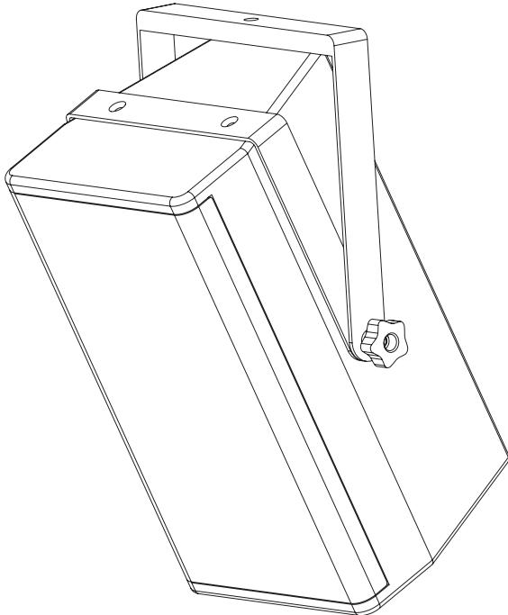
使用附带的M8内六角埋头螺栓，将内轭中的安装孔与音箱顶部或底部的安装点对齐。拧紧螺栓确保牢牢固定。设定了所需的扩音器角度后，拧紧吊篮上的旋钮锁定该位置。吊篮顶部的点可用于永久安装或用于固定钩销。确保在XY-81音箱的后部点上安装M8吊环螺栓，以作为辅助安全装置。
