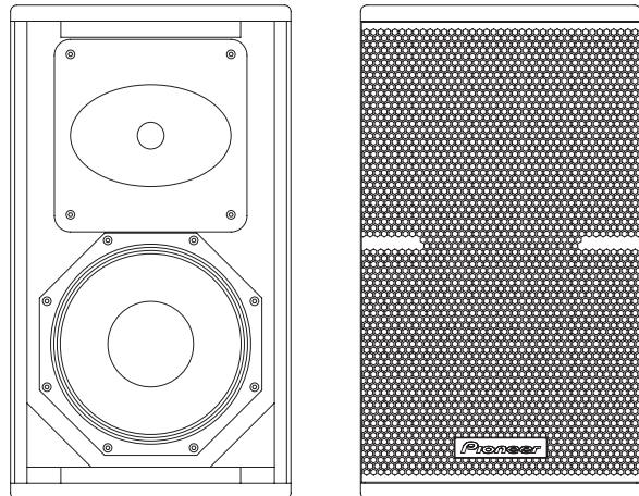
XY-81是一款紧凑型、多功能无源扩音器，适用于各种小型、简约的扩音应用。它的反射式音箱中装有高功率8英寸(203 mm)铁质LF驱动器单元、1.7英寸(43 mm)膜片，以及与90° × 60° 可旋转导波器连接的1英寸(25 mm)喉口钕制高频压缩驱动器单元。这些组件还配有内部无源分频器网络，通过全无源音箱提供无与伦比的音质。
