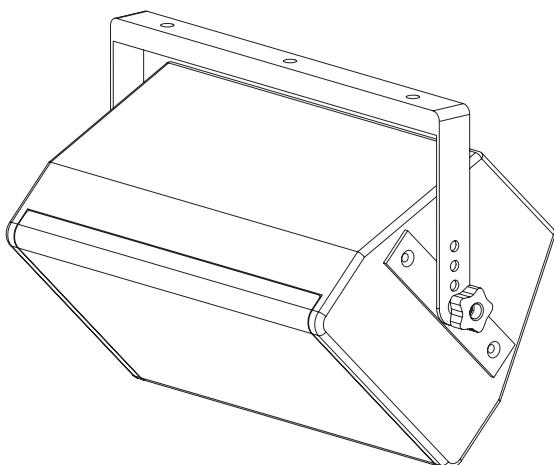
使用附带的M8内六角埋头螺栓，将轭末端安装装置中的安装孔与音箱顶部或底部的安装点对齐。拧紧螺栓确保牢牢固定。设定了所需的扩音器角度后，拧紧吊篮上的旋钮锁定该位置。吊篮顶部的点可用于永久安装或用于固定钩销。确保在XY-81音箱的后部点上安装M8吊环螺栓，以作为辅助安全装置。
